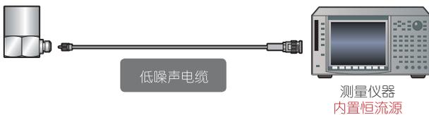
低噪声电缆（原装进口）：LN-023、LN-030……
