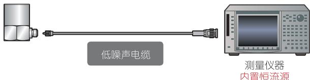
低噪声电缆（原装进口）：LN-023、LN-030……
